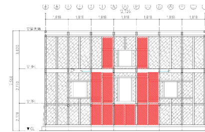
耐震補強壁の配置:赤色部分
