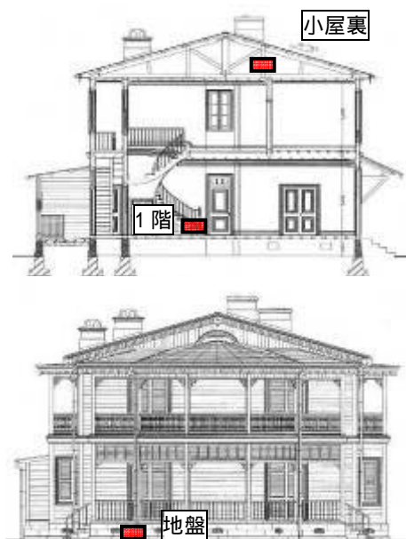
図5 センサー設置状況
